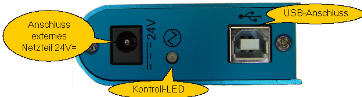
Ansicht der Versorgungsseite
